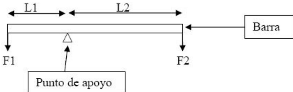
Transforma un movimiento de arco en otro. Es reversible ya que se puede aplicar el movimiento en cualquiera de los dos extremos.
