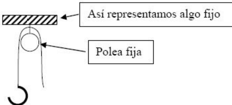
Transforma un movimiento lineal en otro movimiento lineal de distinta dirección. No transforma fuerzas, solo sirve para cambiar la dirección de una cuerda.
